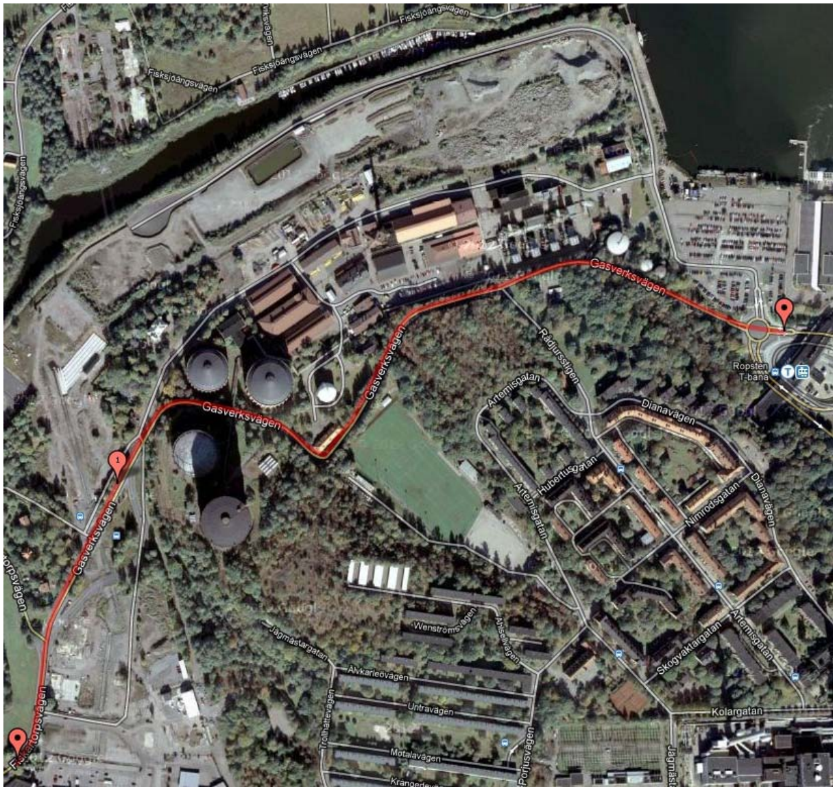
Figur 14. Uppmätning av gasverksvägen i Hjorthagen. Sträckan i figuren är 1,36 km och kilometerpunkten är utmärkt med en etta.
