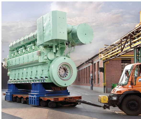
Figur 6. 4-taktsmotor avsedd för framdrift, effekt ca 8500 kW.
