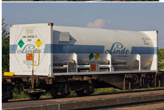
Figur 10 Exempel på tank-containers med ofördelaktig struktur vad avser aerodynamisk prestanda. (bilder från olika hemsidor)
