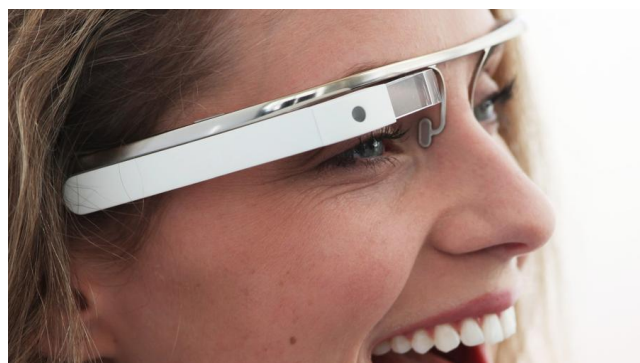
Figur 1. Googles utvecklingsprodukt Google Glass som förväntas lanseras under 2014. Med dessa "glasögon" kan man se en liten display genom att titta uppåt. Google Glass ska även få inbyggd kamera, mikrofon, GPS och en ljudfunktion genom inducerat ljud till skallbenet. Produkten blir röststyrd.
