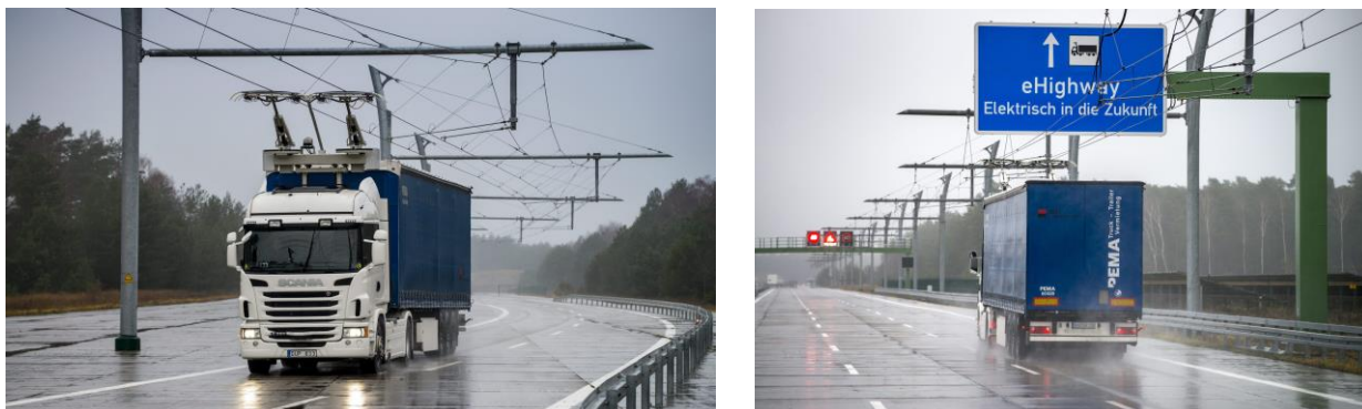
Figur 4.4 Försöksdrift med elöverföring till tunga vägfordon (Scania)
