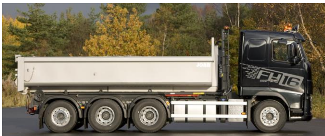
Figur 1.6 Lastbil med lastväxlare för rullflak (Volvo Trucks)
