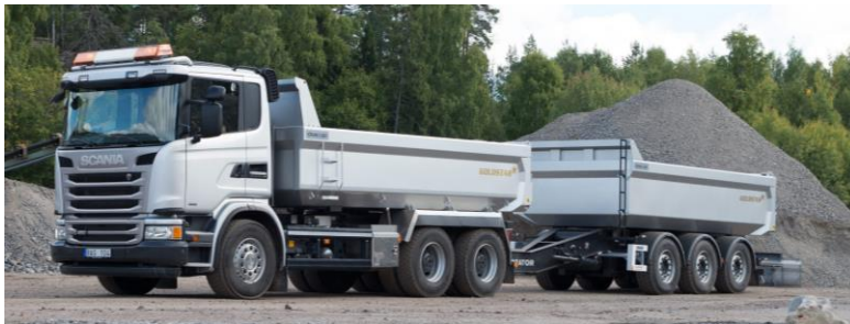
Figur 1.5 Treaxlig tippkärra kopplad till treaxlig lastbil (Scania)
