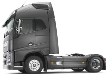
Figur 1.2 Tvåaxlig dragbil (Volvo Trucks) Figur 1.3 Treaxlig dragbil (Scania)
