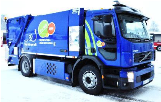
Figur 4.2 Renhållningsfordon med laddhybrid- eller plug-in-hybriddrift (Volvo Trucks)
