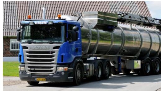
Figur 1.2 Tvåaxlig dragbil (Volvo Trucks) Figur 1.3 Treaxlig dragbil (Scania)
