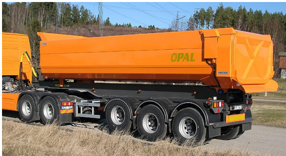
Figur 1.8 Påhängsvagn med tippflak (Parator)
