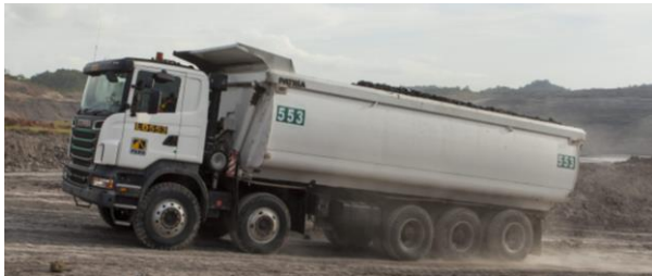
Figur 5.3 Femaxligt anläggningsfordon (Scania)
