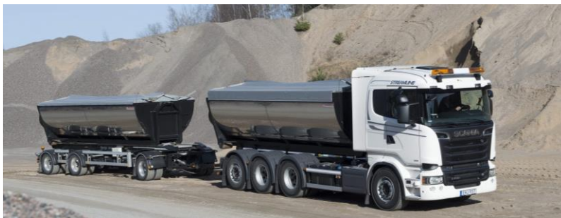
Figur 1.9 Treaxlad tippsläpvagn för rullflak kopplad till fyraxlig lastbil (Scania)
