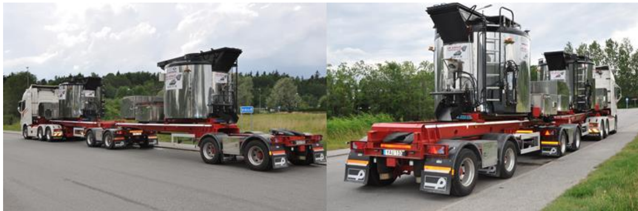
Figur 5.1 Bild till vänster visar ekipaget med utdragna boggin, bild till höger visar indragen boggi (Parator)
