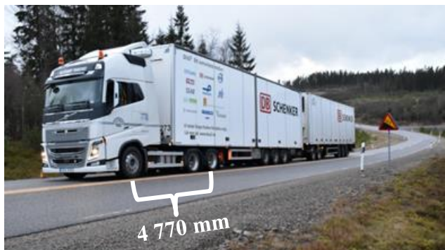
Figur 2.6 DUO-ekipage med dubbeltrailer och med dragbil med kort hjulbas (duo2.nu)
