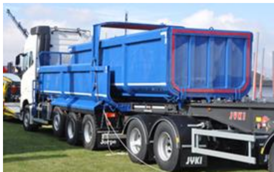
Figur 1.3 Kassettflak som flyttas mellan släpvagn och bil (TFK)
