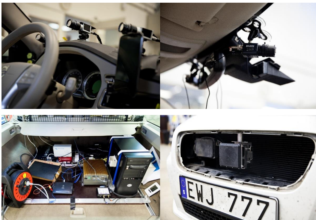
Figur 2. Tre av fem kameror som tillhör eye trackern (övre vänstra bilden), en av de två framåt-kameror som tillhör eye trackern (övre högra bilden), logg-utrustningen i bilens baklucka (nedre vänstra bilden), samt den eftermonterade radarn (nedre högra bilden).
