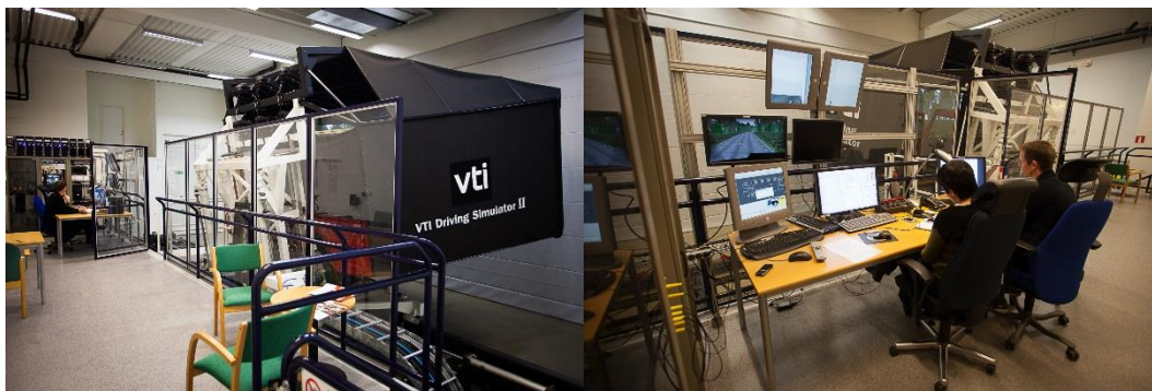
Figur 1. Lastbilssimulatorens inifrån med förare, förarens vy av instrumentpanelen, simulatorens utifrån och experimentledarens plats utanför simulatorens.
