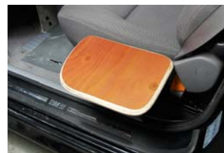
En löstagbar glidplatta kan göra det lättare att komma i och ur förarstolen.
