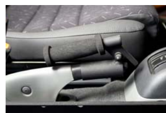
Parkeringsbromsfrigörare monterad ovanpå ordinarie handbroms.
