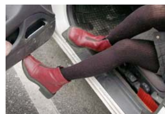
Dörrtröskelns höjd över marken och över golvet i kupén påverkar hur lätt det är att ta sig i och ur bilen.
